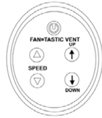
Attic Fan Control
